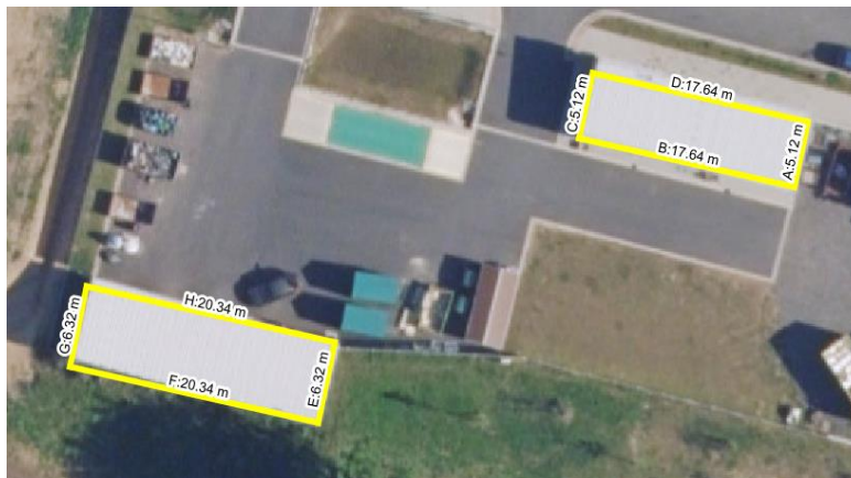
Obrázek 49: Okótovaná střecha objektu – Sběrný dvůr, č.p. 698
