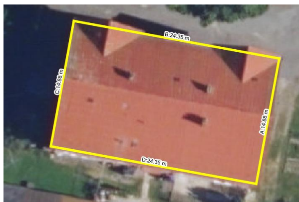
Obrázek 55: Okótovaná střecha objektu – BD Brněnská, č.p. 786
