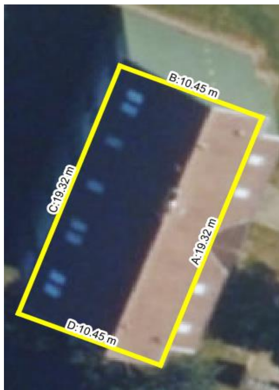
Obrázek 56: Okótovaná střecha objektu – BD K. Čapka, č.p. 783
