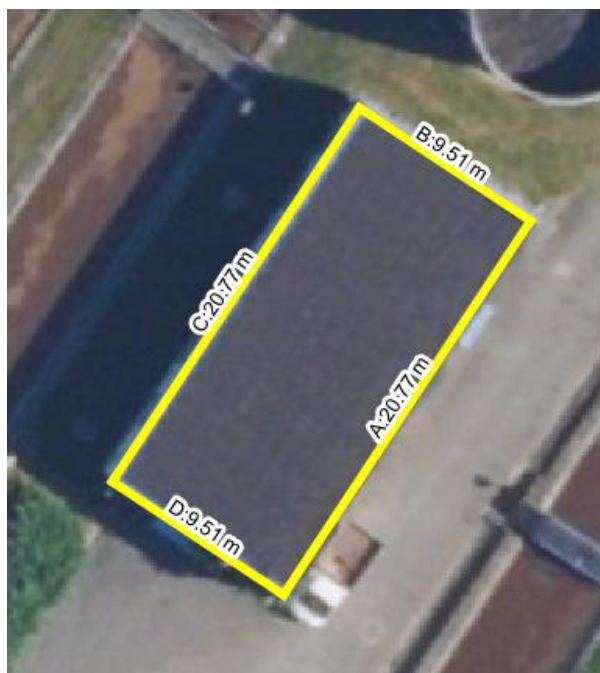
Obrázek 60: Okótovaná střecha objektu – ČOV
